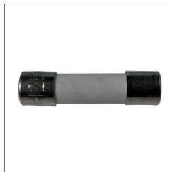
531414 G-Feinsicherung Keramik 5x20 mm T6,3A H 250V
